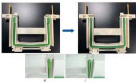
3.1 拆开预制胶包装，将预制胶安装在合适的电泳槽中。
